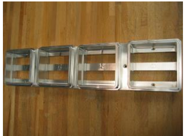
...ricavati da un blocco di alluminio mediante fresatura CAM.
