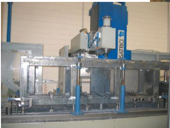
Lavorazione del basamento di una macchina per la produzione di tubo corrugato.
