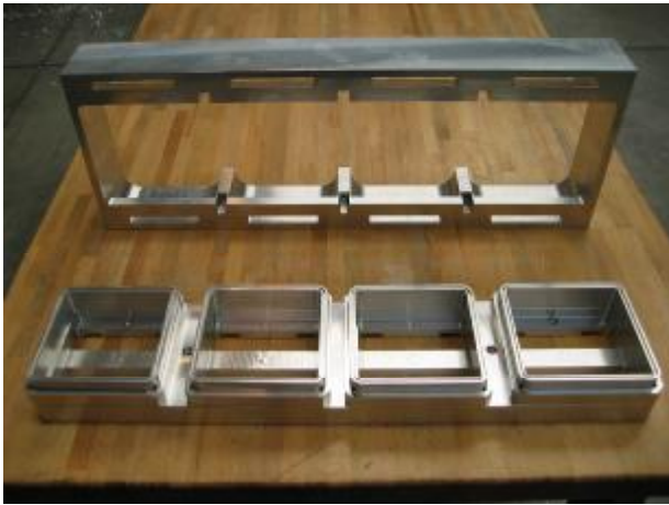
Particolare di uno stampo per macchine Confezionatrici di alimenti in vassoi rettangolari...
