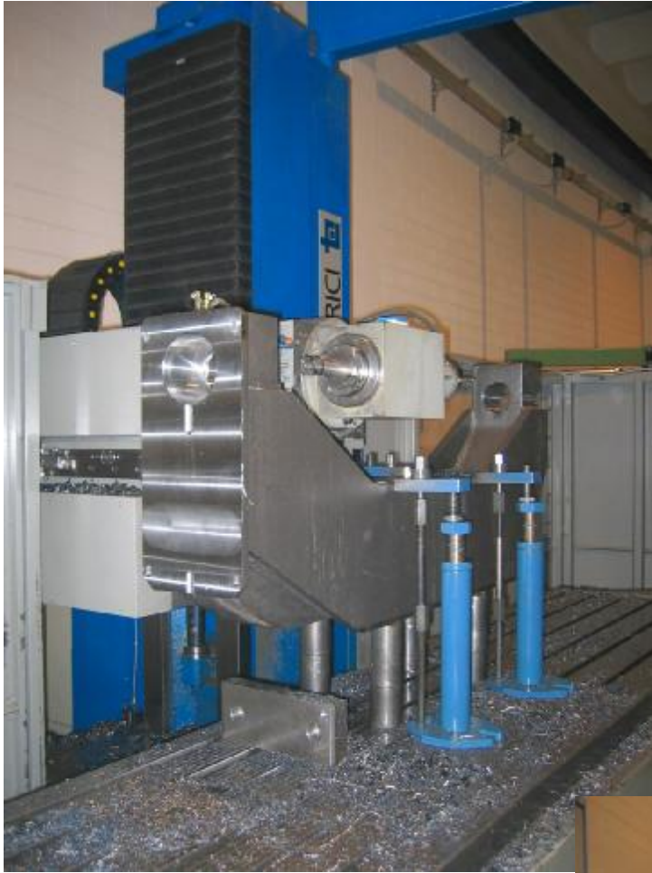
Lavorazione delle pareti interne di una pressa per isola di montaggio.
