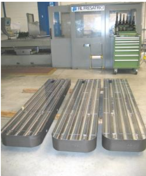
Tavole di base di macchine per lo stampaggio del tubo corrugato in plastica. Planarità in tolleranza \pm 0,02 di millimetro su una lunghezza di mm 2.500. Finitura mediante fresatura, con rugosità \nabla^- 0,8 .
